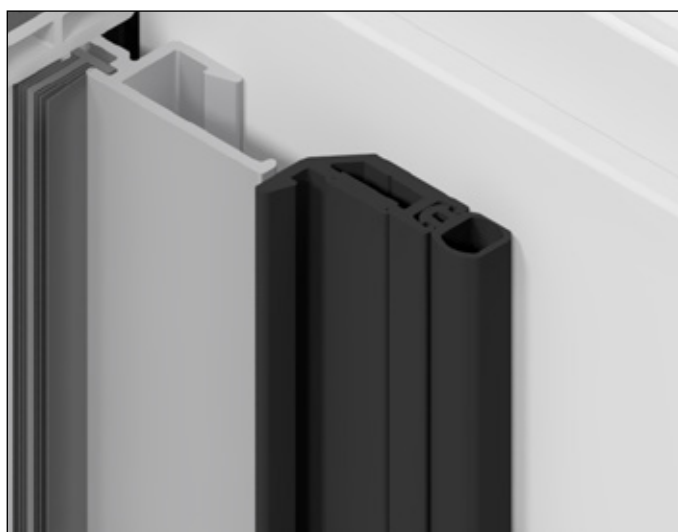
Dichtung HA 3010 in KA MV 19.13 eindücken. Zuschnitt = Zuschnittsmaß KA MV 19.13 optional Abdeckdichtung KA DI 9.2 einziehen.
